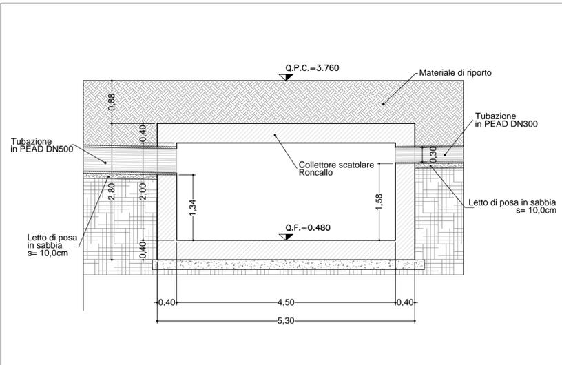
SEZIONE TRASVERSALE POZZETTO DI RACCOLTA ACQUE METEORICHE
