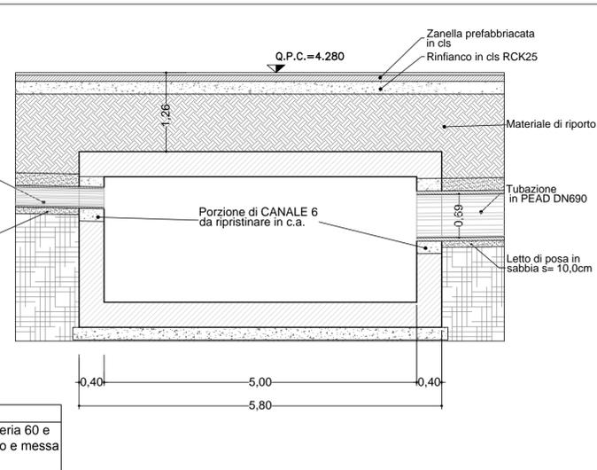
SEZIONE LONGITUDINALE POZZETTO DI RACCOLTA ACQUE METEORICHE
